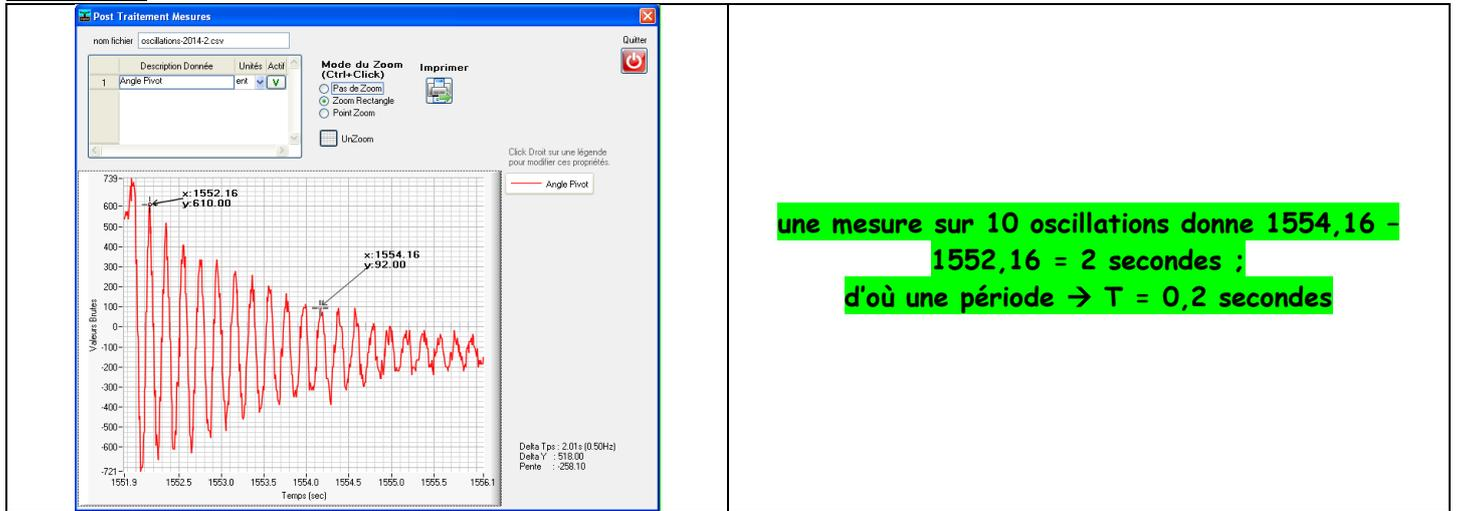
1-2 Exploitation des résultats d'expérimentation par résolution de l'équation différentielle issue du Principe Fondamental de la Dynamique :
