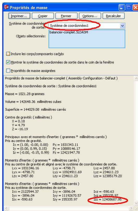
on obtient au final une inertie par rapport à l'axe de pivotement, de  $12,4 \cdot 10^6 \text{ g}\cdot\text{mm}^2$  soit :  $12,4 \cdot 10^{-3} \text{ kg}\cdot\text{m}^2$  néanmoins dans cette simulation, les moteurs ont été dessinés comme des corps en acier pleins, ce qui n'est pas le cas en réalité ; une valeur voisine de  $10 \cdot 10^{-3} \text{ kg}\cdot\text{m}^2$  paraît donc plus probable
