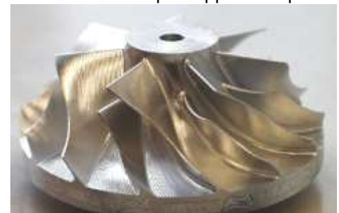
Exemple de pièce complexe obtenue par usinage
