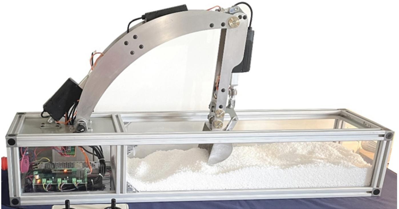
Le **Bras de pelleteuse électrique autonome** est un produit inspiré des nouvelles générations de pelleteuses compactes **électriques** que les constructeurs commencent à développer afin de diminuer leur impact environnemental.
