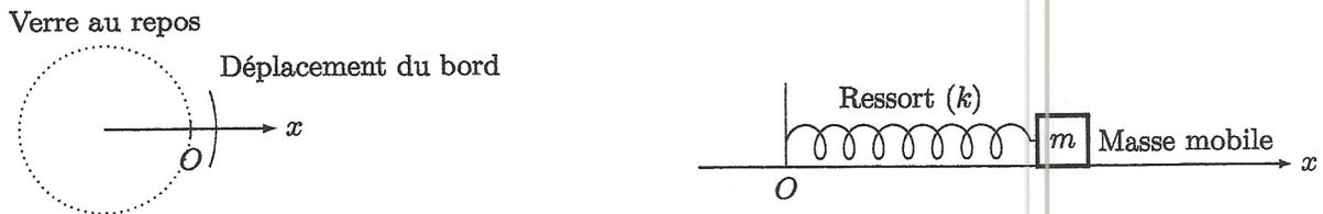
Figure 6 Modèle mécanique du déplacement
