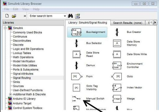
2/ Utiliser un "Switch" pour simuler l'état d'une entrée
