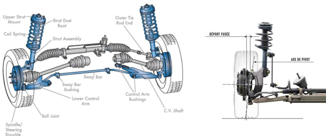
Le quart de véhicule est modélisé par une masse  $M$ , la suspension est modélisée par un système ressort-amortisseur,  $K_{\text{susp}}$  représente la raideur du ressort et  $f_{\text{susp}}$  le coefficient de frottement visqueux de l'amortisseur (trous calibrés de passage de l'huile au travers du piston de l'amortisseur hydraulique).
