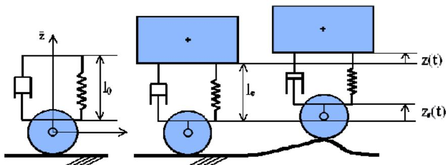
Une étude mécanique réalisée sur le modèle du quart de véhicule nous donne l'équation différentielle liant le déplacement  $z(t)$  du châssis du véhicule (grandeur de sortie) au déplacement  $z_r(t)$  imposé sur l'axe de roue par le profil de la route (grandeur d'entrée).
