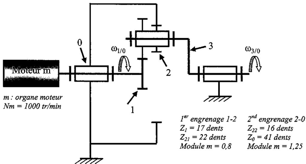
L'arbre planétaire (1) est l'entrée du système, le porte satellite (3) est la sortie. Le satellite (2) possède deux roues dentées. La première roue dentée est le planétaire central (1). La dernière roue est la couronne (0). On cherche à déterminer la vitesse de rotation en sortie  $\omega_{3/0}$ .
