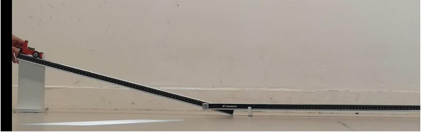
Le dispositif d'étude ci-dessus permet de simuler les échanges énergétiques avec un véhicule sur un rail incliné et horizontal.
