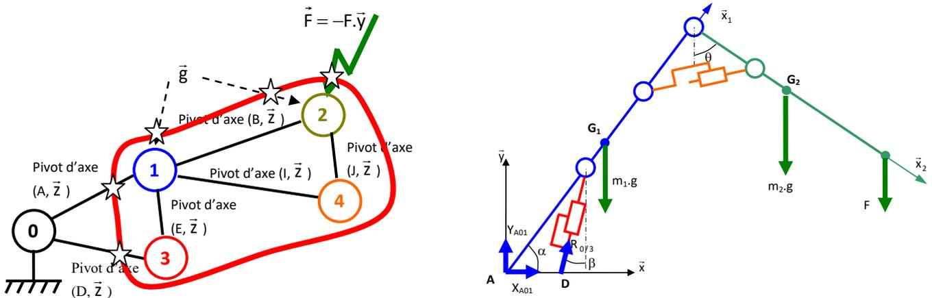
Cet isolement et l'écriture du PFS en point A permet de déterminer directement  $R_{03}$  en fonction de données connues grâce au théorème du moment statique projeté sur l'axe  $\vec{z}$ .
