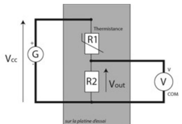
\* Un pont diviseur de tension est un montage qui permet de diviser la tension d'alimentation ( $U_{\text{AC}}$ ). Ainsi la tension de « sortie » va pouvoir varier de 0 à 5V.
