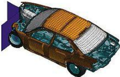
Simulation numérique d'un essai de choc sur une voiture : les cellules utilisées pour le maillage sont visibles sur la surface du véhicule
